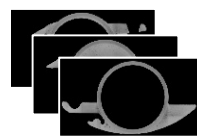
【CTスキャン】例 (アルミ鋳物の連続断面及び欠陥検出)
