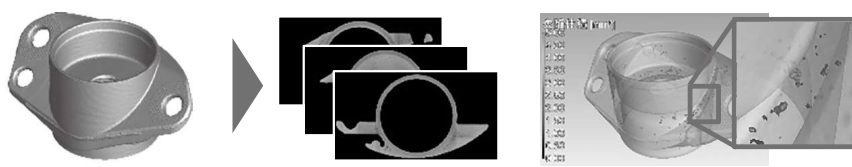
【CT スキャン】例（アルミ 鋳物の連続断面及び欠陥検出）
