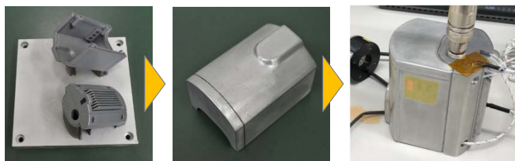
【金属積層造形を用いたケースの試作】
