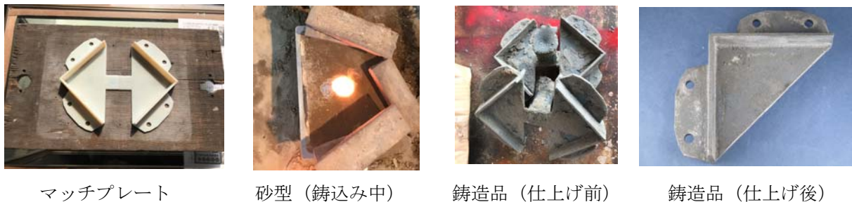
図12 3D積層モデルによるマッチプレートおよび鋳造品
