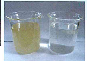
処理前の原水 (左: 100ppm原油/水エマルジョン)と処理水(右)
