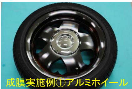
複合サイクル試験(1ヶ月)後_外観観察 基材: マグネシウム合金(AZ91D)
