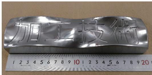
ハイスピードミーリングセンターによる加工事例
