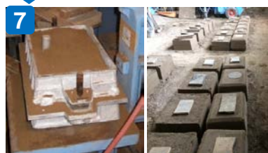
マッチプレート使用して砂型を造形
