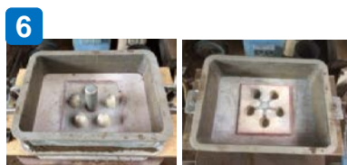
木型等と組み合わせてマッチプレートを作製
