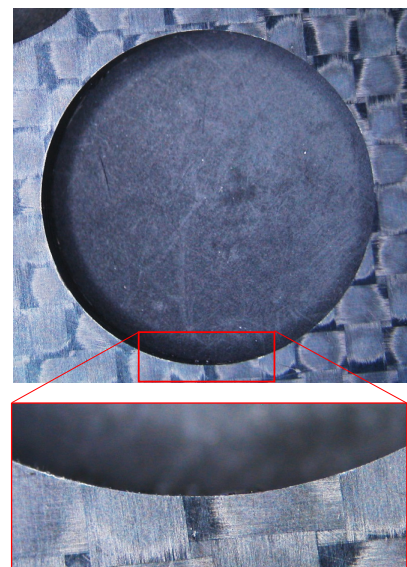
図10 研削穴あけを行った穴の例
