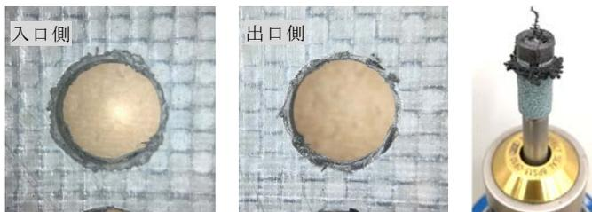
b) 液体窒素中での研削穴開け加工
