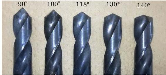
図4 工具先端角度を調整したドリルの外観
