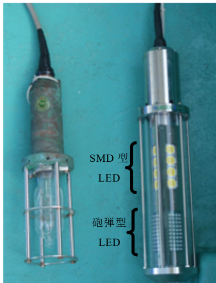
図 4 既存灯 (ハロゲン灯) と開発した LED 灯
