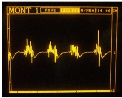
図 10 市販の生体計測装置による筋電図計測
