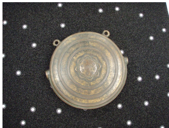
図2 ターゲットシート上に測定対象物に乗せた状況
