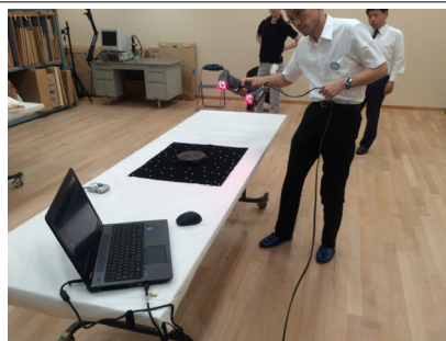
図3 鱈口の形状測定の様況
