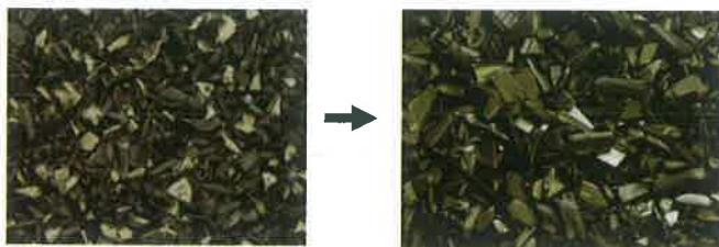
図 9 処理前後のウレタンフォーム裏打ち材
