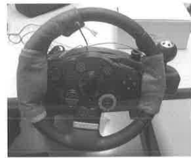
図 13 生体電位計測用電極の応用例.
