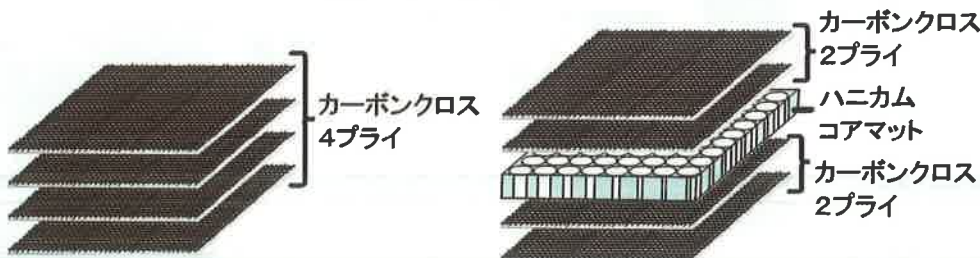
図 11 作成した CFRP の積層構造
