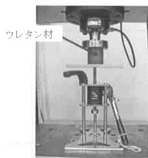
図 11 圧縮力測定状況
