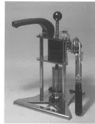
図 2 5 家庭用小型搾油機の試作機の完成写真
