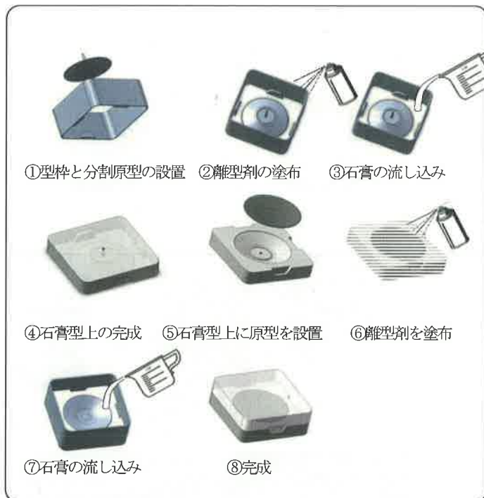
図10 石膏型（元型）製作過程
