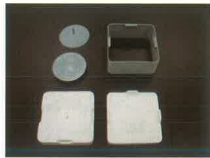
図11 石膏型（元型）完成品と原型モデル
