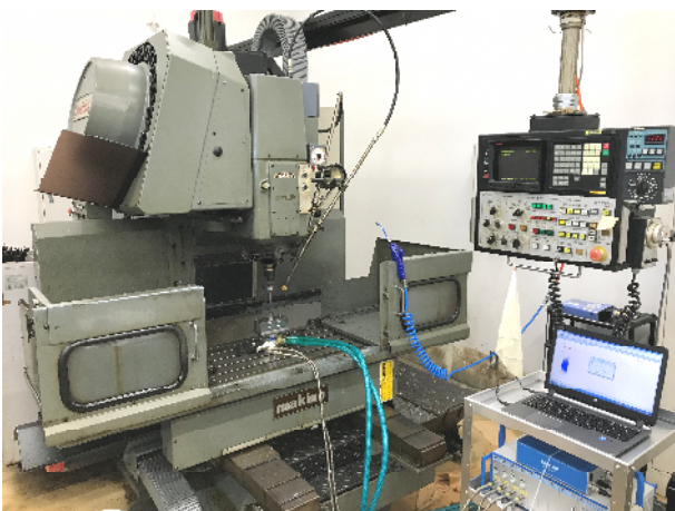
図3 タッピングトルク試験装置
