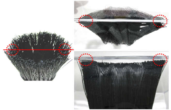
図10 円形状のブラシを隅に当てた際の変形
