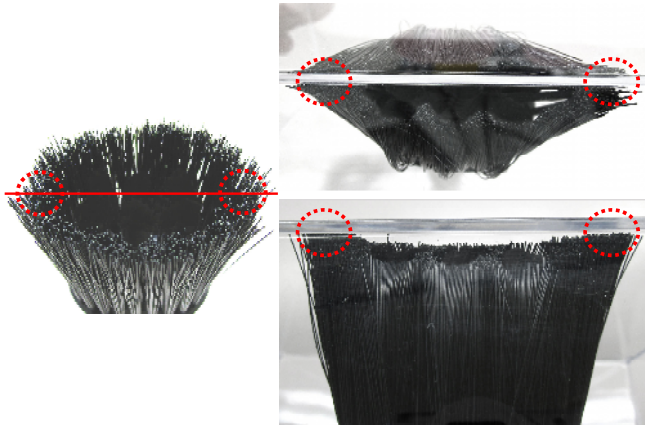
図10 円形状のブラシを隅に当てた際の変形
