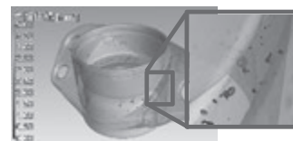
【CTスキャン】例（アルミ鋳物の連続断面及び欠陥検出）
