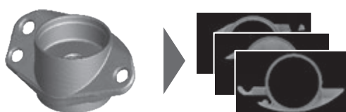
【CTスキャン】例（アルミ鋳物の連続断面及び欠陥検出）
