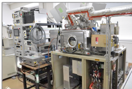
成膜装置(反応スパッタリング装置)
