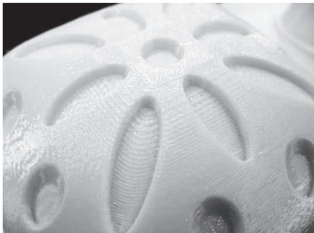
図1 造形物の積層痕の例
