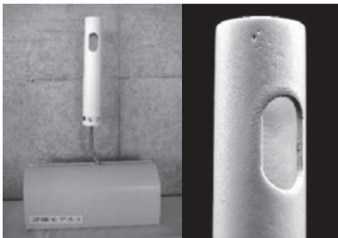
(c) 評価モデル 3(研磨仕上げ+スプレー塗装)
