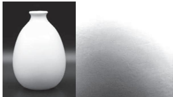
(f) 評価モデル 6(研磨仕上げ+スプレー塗装)
