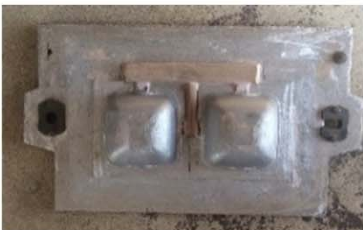
樹脂+木型の元型からアルミ鋳造 によりマッチプレートを製作
