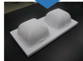
3Dプリンターによる樹脂モデルの 製作コスト抑制のため中空モード で造形
