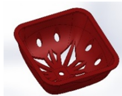
3D-CADで原型を設計 抜き構造、収縮考慮
