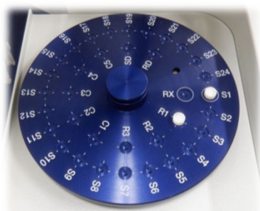
図. サンプルチェンジャ (最大24試料)
