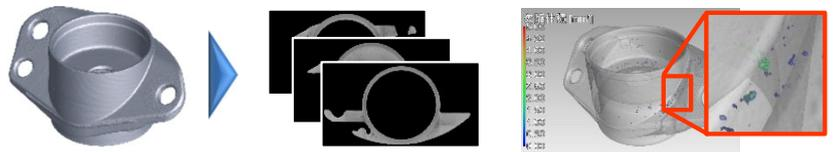
【CTスキャン】例（アルミ鋳物の連続断面及び欠陥検出）
