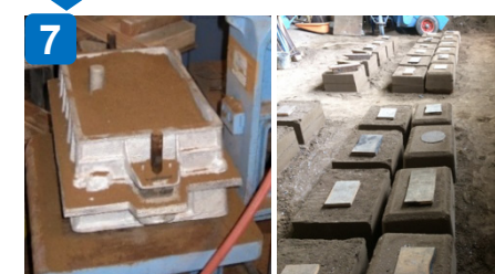
マッチプレート使用して砂型を造型
