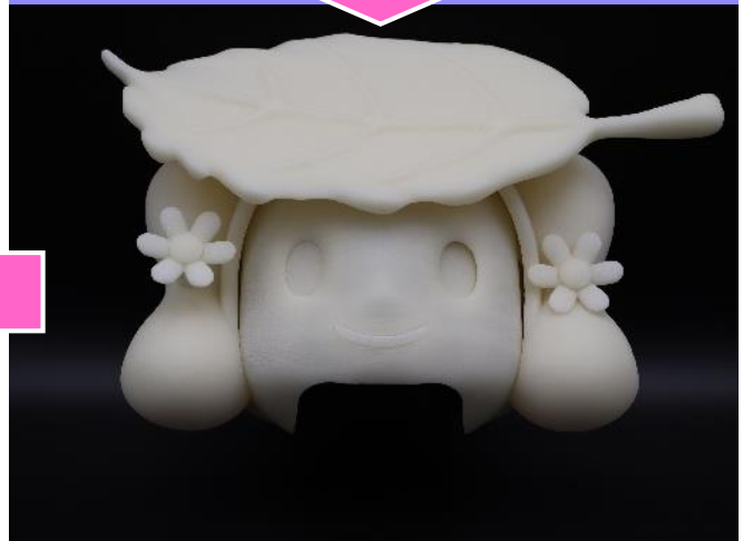
粉末焼結式樹脂造形機によるモデル作製
