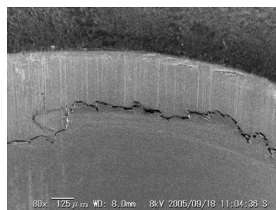
被加工物加工面 Ti-Al-N皮膜処理パンチ 100,000 回
