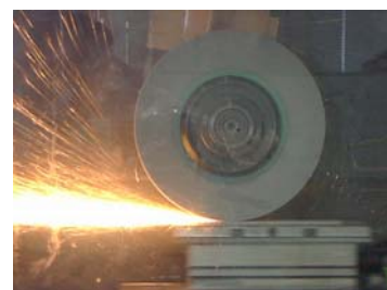
WA46によるドライ加工 (S50C, V:25m/s, v:0.25m/s, t:10 \mu m)
