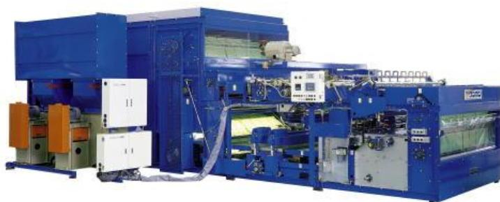
新型乾海苔製造装置『ワンマンNQ型』
