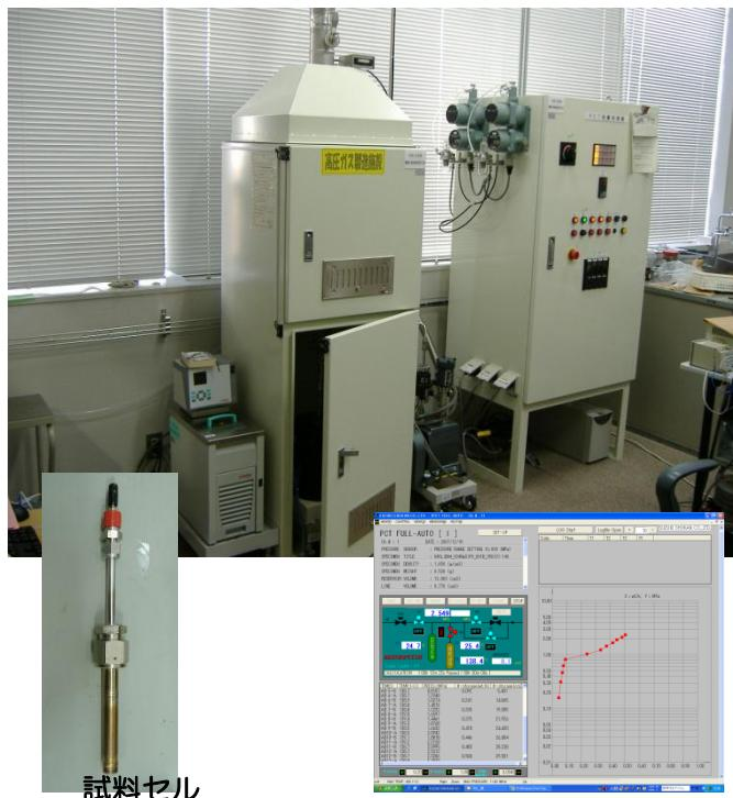
水素貯蔵材料特性評価(PCT測定)
