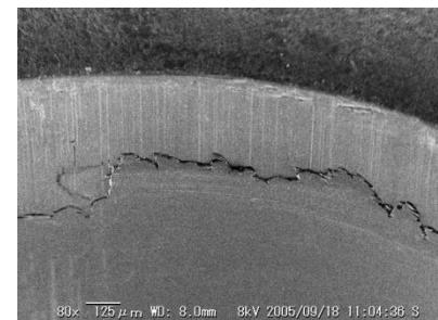
被加工物加工面 Ti-Al-N皮膜処理パンチ 100,000 回
