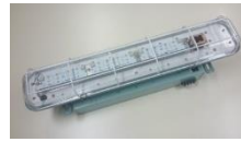
開発したLED照明器(光無線LAN AP)、送受信モジュール
