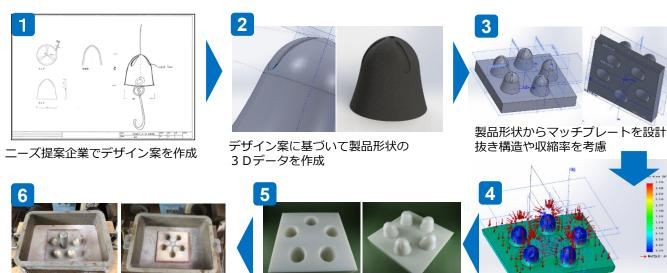
構造シミュレーションを用いて砂型造 型時の想定される圧力で強度を確認
