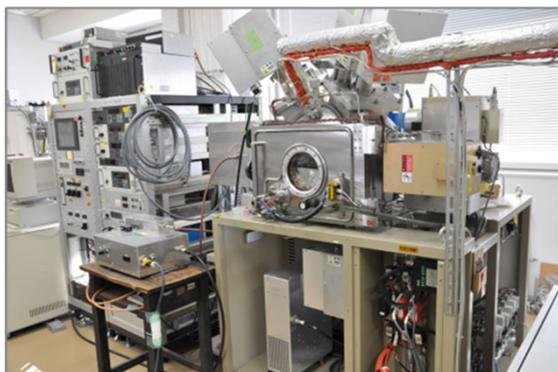
成膜装置(反応スパッタリング装置)
