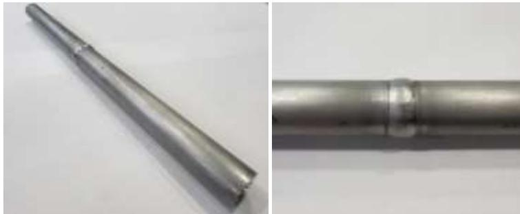
開発した技術による配管の溶接例
