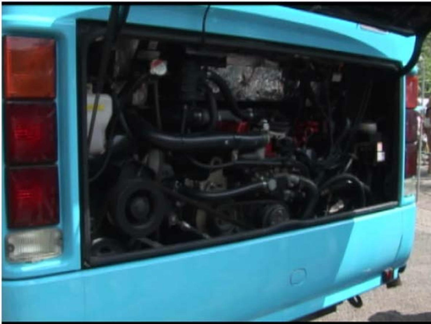
武蔵11号車（2009年）可変ターボ過給リーンバーン吸気管噴射火花点火水素エンジンバス
